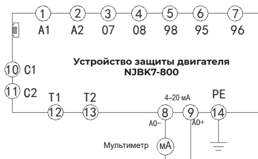
Рис. 16. Схема соединений проверки интерфейса 4–20 мА
